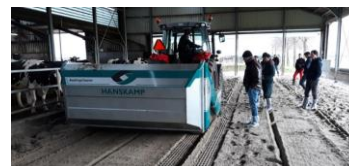
Vrijloopstal met zandbedding (vrijloopstal) en BeddingCleaner die de mest van de zandbedding oppikt
