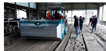
Szabadforgalmú istálló alomtisztítóval (BeddingCleaner) ami a trágyát a homokról felszedi
