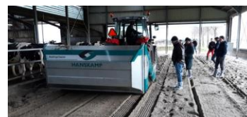
Freewalk hlev s peščeno podlago (Free-Living Barn) in BeddingCleaner, ki pobere iztrebke s peščene podlage
